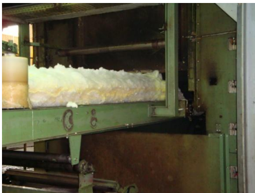
Vhod v trdilno komoro
