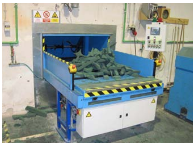
Mlin za gobo - notranji del s kontrolnimi tipkami in računalnikom
