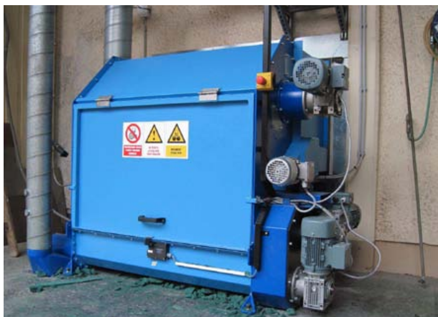
Mlin za gobo - zunanji del z odsesovalnimi cevmi in motorji
