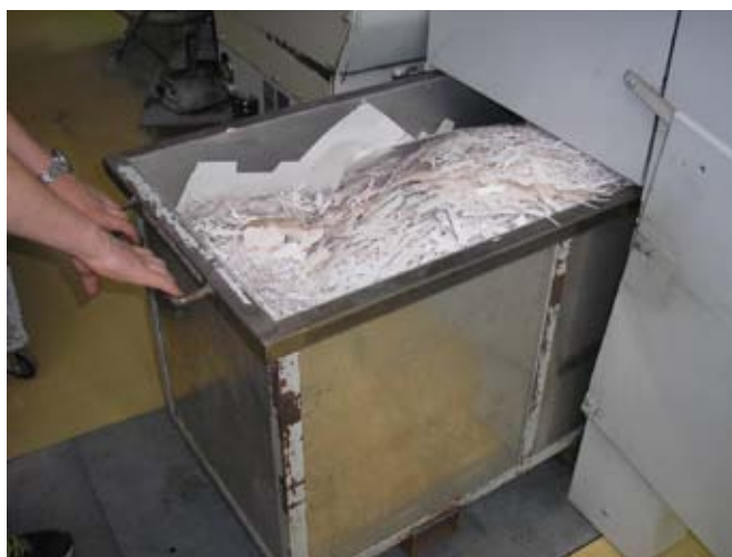
Slika 1: sistem odvajanja odpadkov pred uvedbo tekočega traku. Pod strojem je voziček za zbiranje odpadkov. Praznjenje polnega vozička je potekalo ročno.
