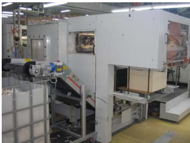
Slika 2: trak za odvajanje odpadkov je vstavljen pod stroj. Odpadke odvaja v večji kontejner.
