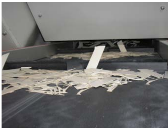
Slika 3: kartonski odpadki padajo na trak pod strojem.
