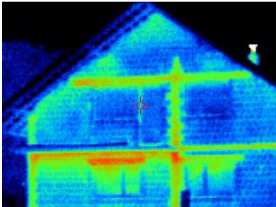
Termografija (toplotna slika) stavbe brez in s toplotno zaščito
