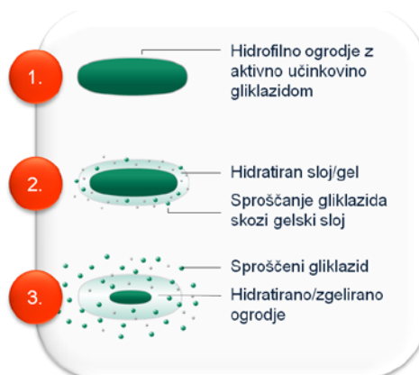
Priloga 3: Shematični prikaz sproščanja zdravilne učinkovine iz tablet predmetne inovacije
